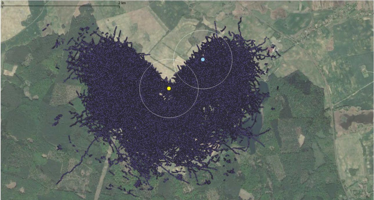
Abbildung 32: Beispielhafte räumliche Verteilung von während drei Tagen (25.06./06.07./18.07.) als „large_raptor“ klassifizierten Messpunkten am Komplexstandort im Sommer 2022. Dargestellt sind die zwischen Morgen- und Abenddämmerung vom BirdScan-System als „large_raptor“ klassifizierten Messpunkte (nicht nachbestimmt). Deutlich sichtbar ist der Effekt der defekten nach Norden ausgerichteten Antenne. Dunkelblau=Messpunkte, gelb=Standort BirdScan Komplexstandort, hellblau=Standort BirdScan Offenlandstandort, weiße Kreise=Radius Abstandszylinder 502 m
