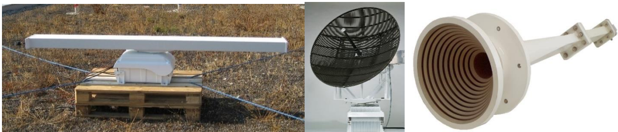
Abbildung 6: Beispiele von Radarantennen (links: Balkenantenne, Mitte: Parabolantenne, rechts: Hornantenne). Die Form des Radarstrahls hängt vom Typ der Antenne ab. Fotos: Balkenantenne und Parabolantenne (© Archiv Schweizerische Vogelwarte), Hornantenne (Averse, CC BY-SA 3.0)
