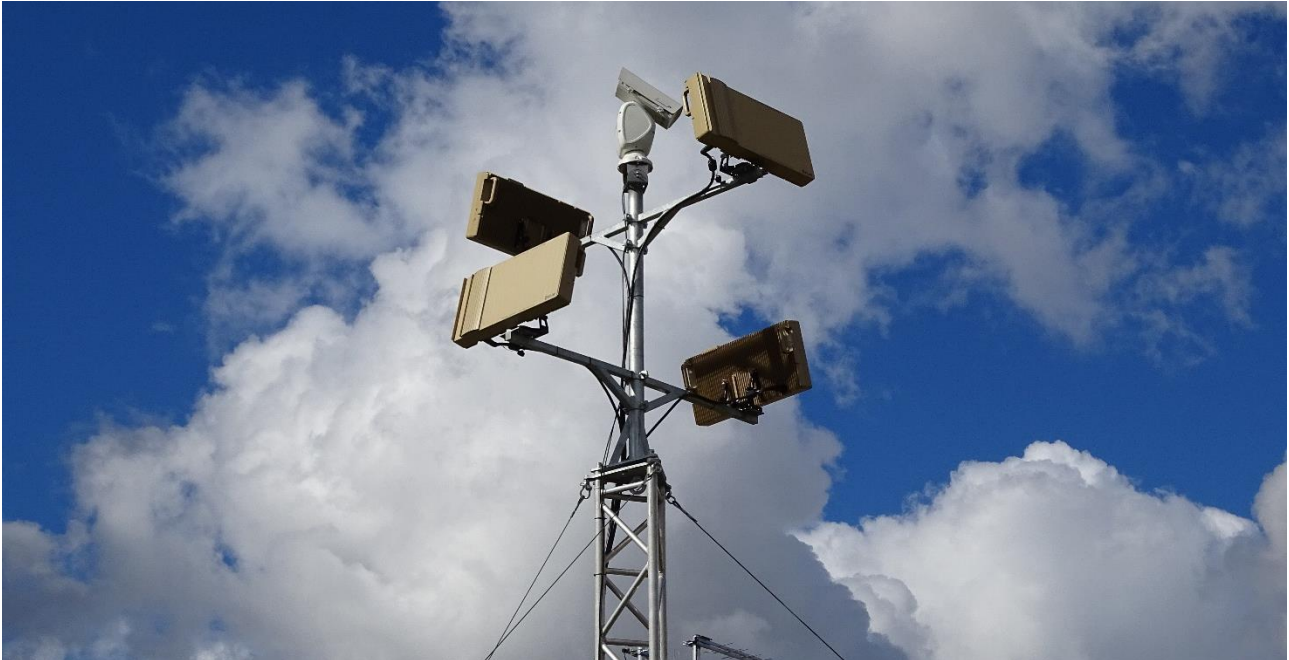
Abbildung 7: Radarsensoren des Radarsystems BirdScan MS1. Für die vorliegende Untersuchung sind vier Radarsensoren eingesetzt worden. Diese sind so angeordnet, dass der Luftraum im Umkreis von 360° überwacht werden kann (Foto: Janine Aschwanden).
